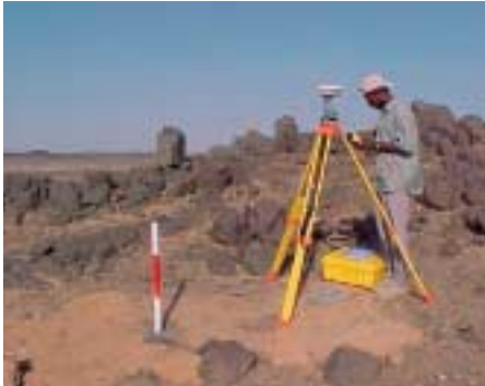
GPS-Messung auf einem von 200 Neupunkten
